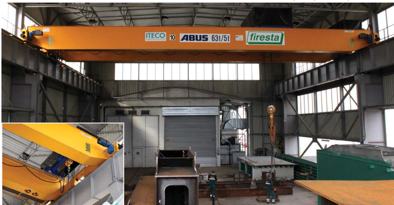
Dvounosníkový mostový jeřáb ITECO-ABUS – ZLK 63/19,2 MD s detailem druhého, zakrytovaného kladkostroje
