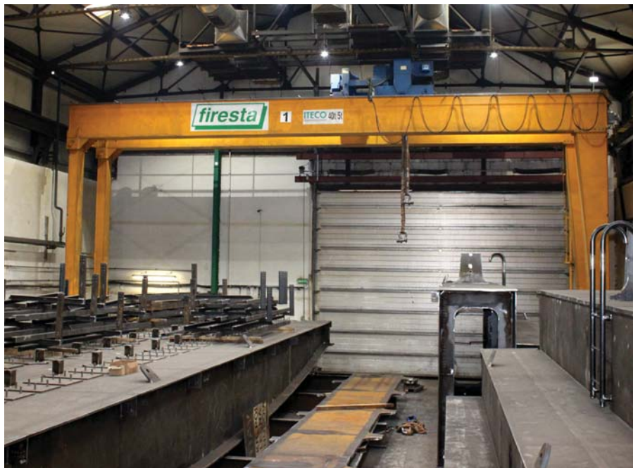
Portálový jeřáb ITECO – PM 20+20-5/10,5 MD v hale svařovny
