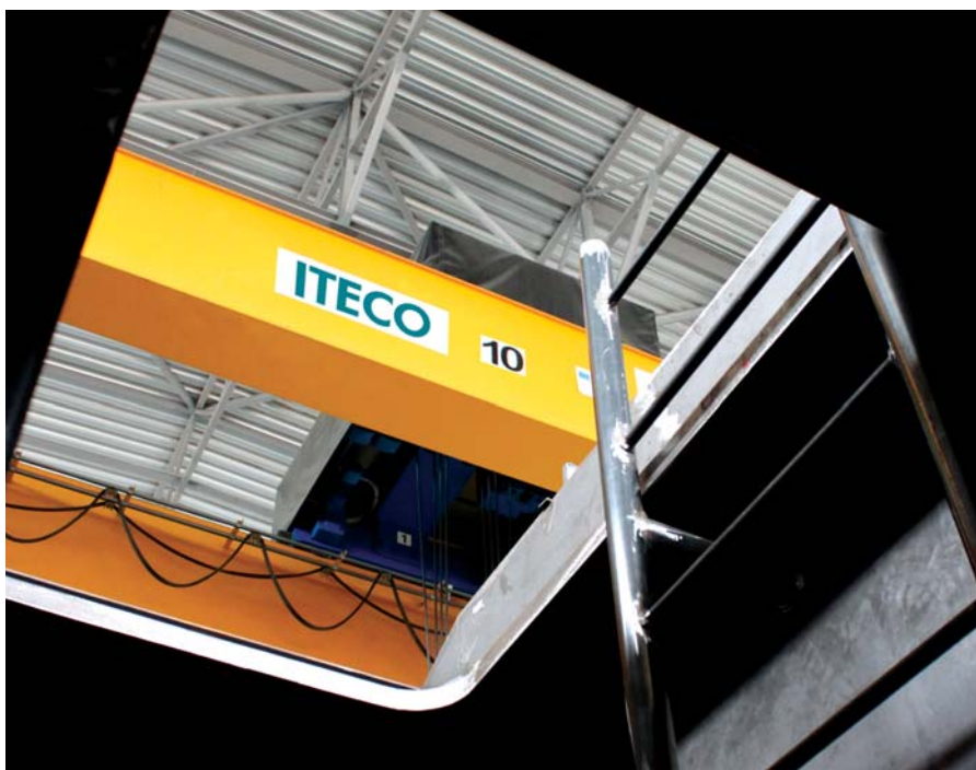
Dvounosníkový mostový jeřáb ITECO-ABUS – ZLK 63/19,2 MD s detailem druhého, zakrytovaného kladkostroje
