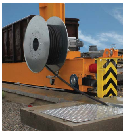
Motorový buben s kabelem napájení jeřábu
